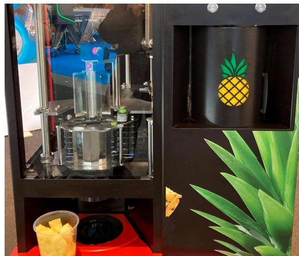
Ananas-Schneidemaschine: Die Pina Royal von Hepro verarbeitet frische Ananas in unterschiedlichen Kalibern. Ein patentiertes Anti-Fruchtfliegen-System ist integriert.
